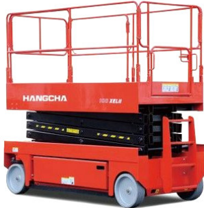
Eingefahrener Zustand zum Rangieren und Transportieren
