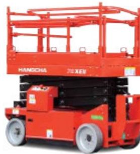
Geländer abgeklappt, Durchfahrts Höhe nur 197 cm!
